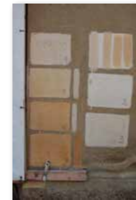
Připravené vzorky vápenného nátěru, tónovaného zelenou skalicí, ukazující přirozenou barevnou škálu tohoto tradičního prostředku, 2012.
